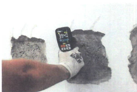
Foto 3 – Determinarea vitezei de propagare a ultrasunetelor
