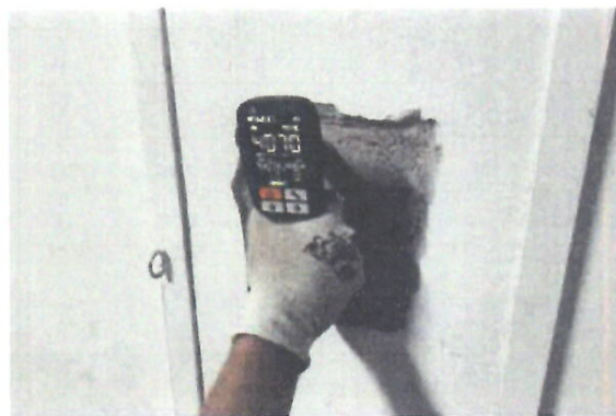
Foto 3 – Determinarea vitezei de propagare a ultrasunetelor
