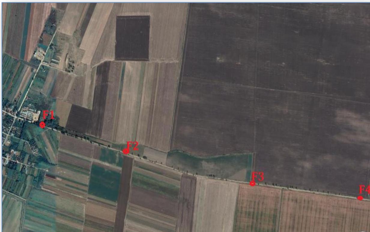
PLAN DE SITUATIE FORAJE GEOTEHNICE
