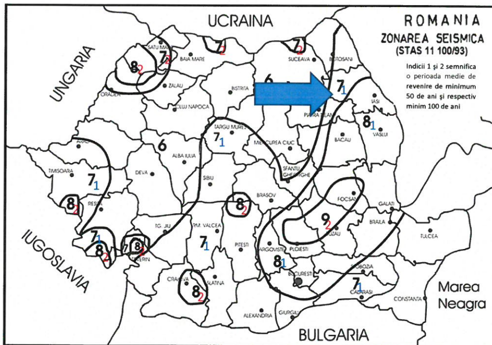
Fig. 7 – Zonarea Teritoriului din punct de vedere seismic
