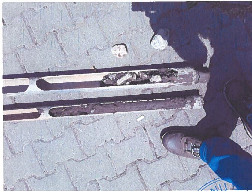
Figura 10.a: Stratificația întâlnită în forajul F1
