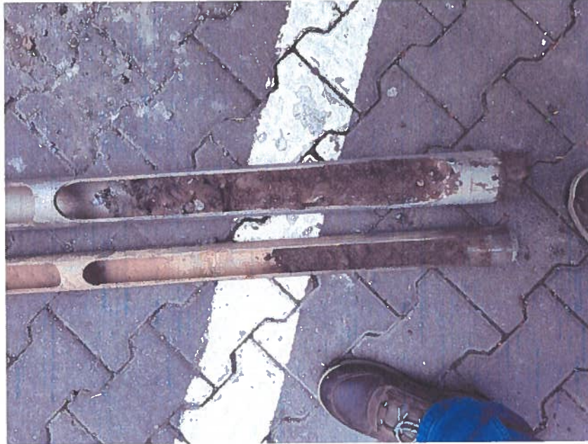
Figura 10.a: Stratificația întâlnită în forajul F1
