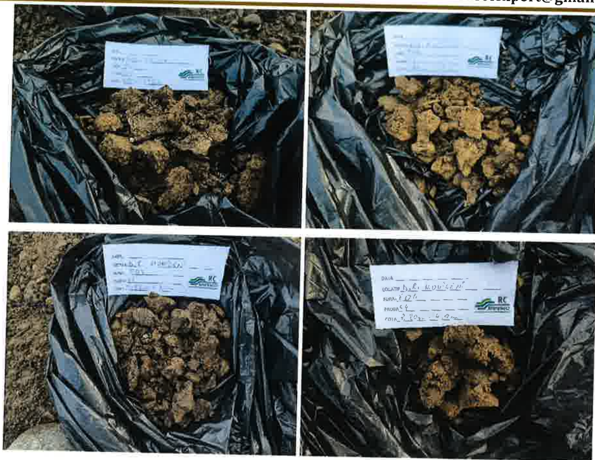
Fig. 17. Investigații geotehnice și prelevare probe de pământ
