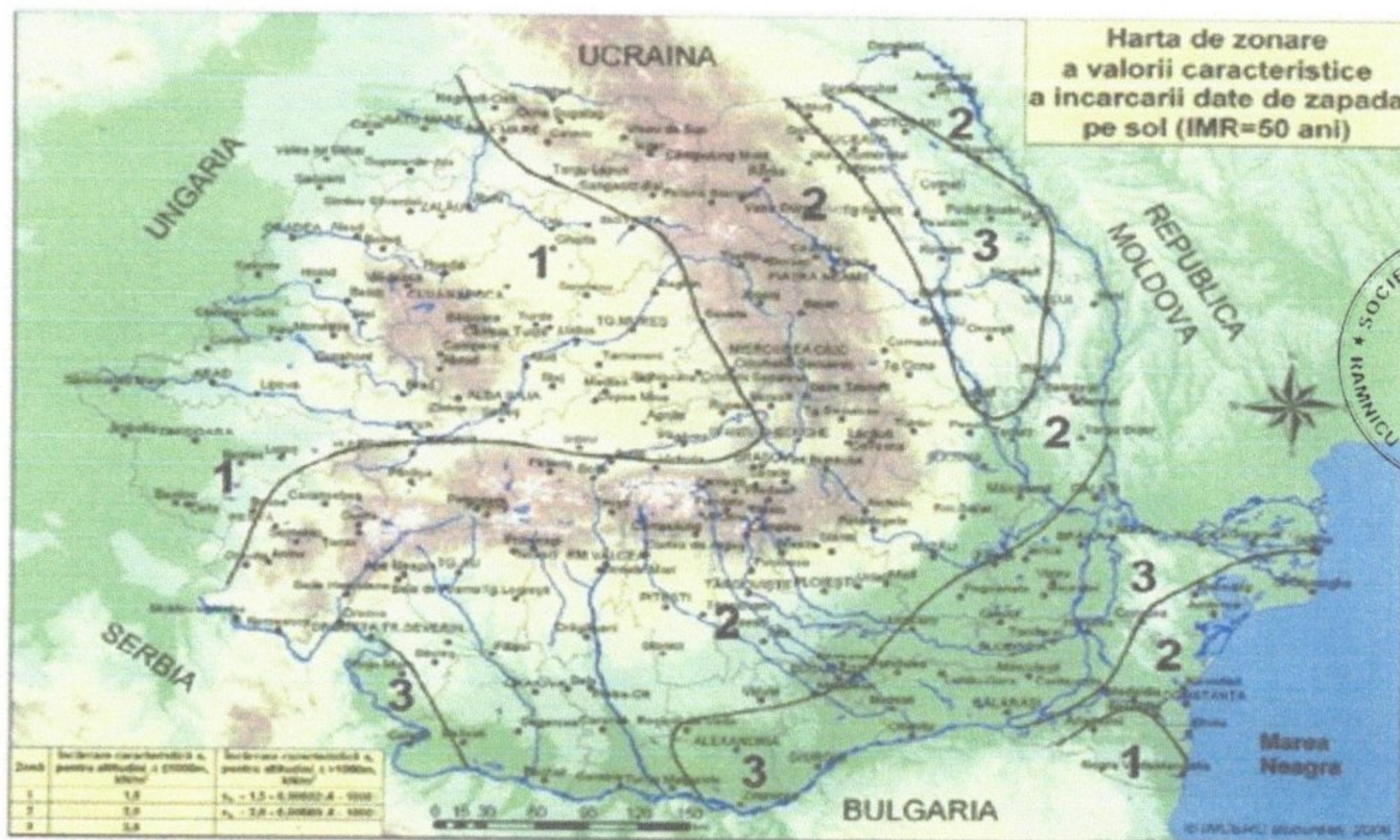
Figura NA.1 – Harta de zonare a valorii caracteristice a încărcării date de zăpadă (interval mediu de recurență IMR = 50 ani)
