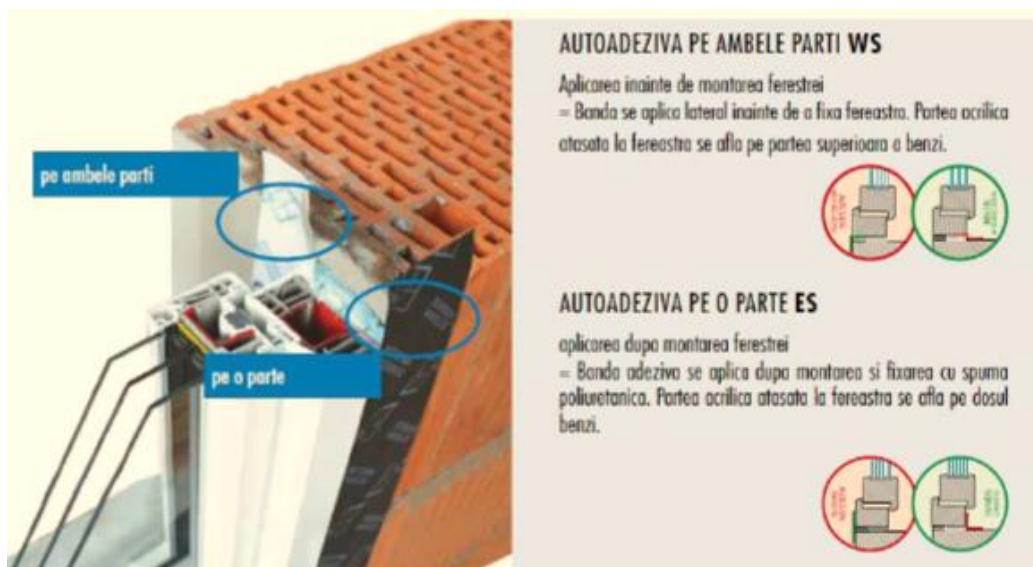
Figura 29 Soluție de etanșare cu benzi
